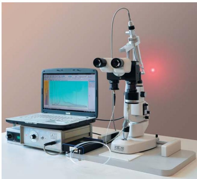
1. Лазерно-волоконный источник, система доставки излучения на глазное дно, для проведения ФДТ с использованием щелевой лампы XCEL 250.
